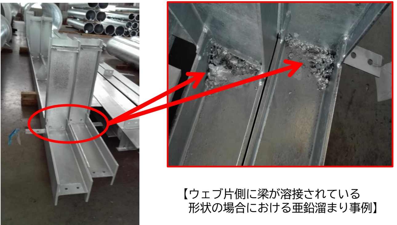
【飛行機梁タイプの垂鉛溜まり事例】
