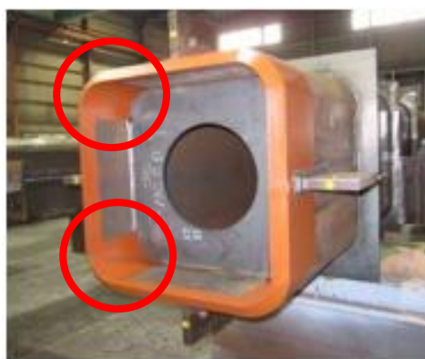
角型鋼管の平部および角部内側にめっき処理をした例
