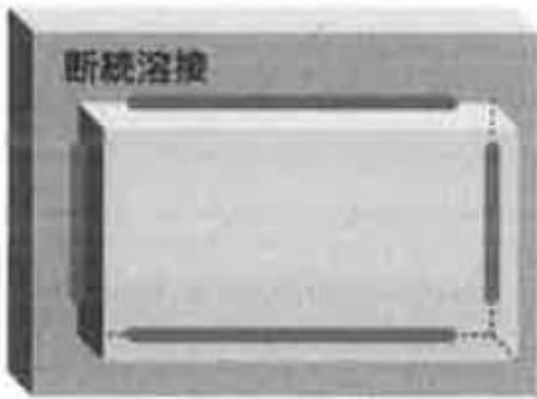
断続溶接による重ね合わせ
