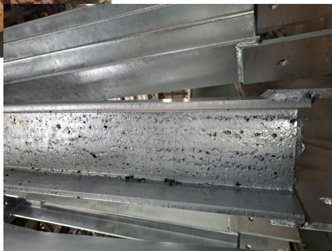
極端な赤さびが要因によるめっき
