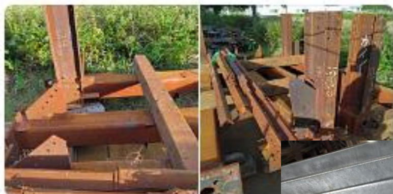
極端な赤さびが発生した製品
