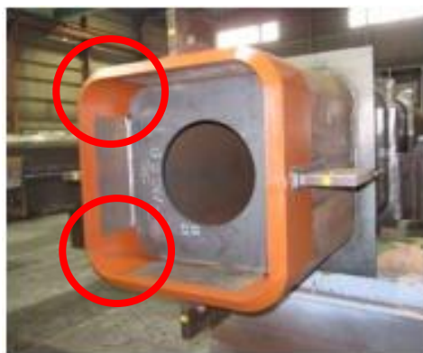
角型鋼管の平部および角部内側にめっき処理をした例
