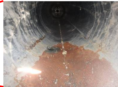
空気抜き孔が隅にないために発生したパイプ内面の不めっき
