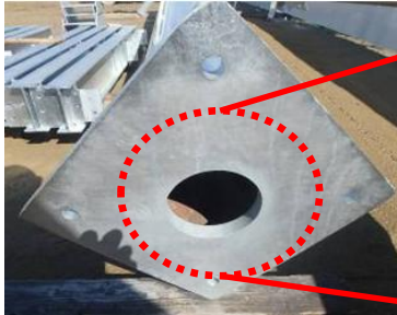
空気抜き孔が隅にないために発生したパイプ内面の不めっき
