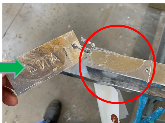
金札を剥がすと表面に剥離発生
