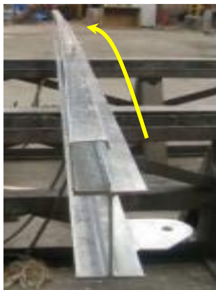
上部片側にだけ部材を溶接したために曲がりが発生した例
