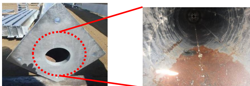
空気抜き孔が隅にないために発生したパイプ内面の不めっき
